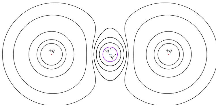
Um die beiden Spiegelladungen  $-q'$  im Zentrum der Anordnung herum verläuft die Linie für  $\varphi = 0$  V (in violetter Farbe, hieran ist zu erkennen, dass die geerdete Kugel durch diese Anordnung sehr gut angenähert wird). Weiter von innen nach außen verlaufen die Linien für  $\varphi = 10$  V, 15 V, 18 V, 20 V, 25 V, 40 V, 60 V und 80 V.
