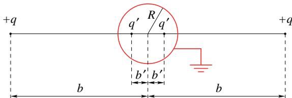
Die Spiegelladungen im Inneren der Kugel mit dem Radius  $R$  können dabei so gewählt werden, dass das Potenzial auf der Kugeloberfläche verschwindet. Damit wäre die Randbedingung der geerdeten Kugel aus der Aufgabe eliminiert.
