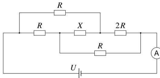
Berechne den Widerstand  $X$ , sodass bei einer Spannung von  $U = 5\text{ V}$  das angeschlossene Amperemeter einen Strom von  $I = 42,0\text{ mA}$  anzeigt!
