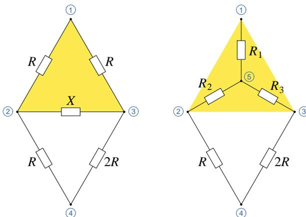
Der Widerstand  $X$  verhindert es hier, dass der Gesamtwiderstand  $R_{\text{ges}}$  zwischen den Knoten ① oben und ④ unten einfach mit den Gesetzen der Reihen- und Parallelschaltung von Widerständen berechnet werden kann.
