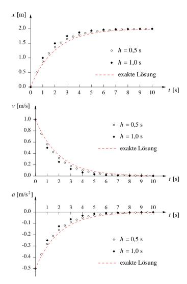
Es ist deutlich zu erkennen, dass die Konvergenz an die analytische Lösung mit abnehmender Schrittweite besser wird.
