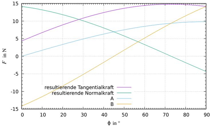
Das oben berechnete Maximum der resultierenden Tangentialkraft ist bei  $\varphi \approx 73^\circ$  gut zu erkennen, während die resultierende Normalkraft im gesamten Bereich positiv ist, d. h., die Punktmasse verliert nirgends den Kontakt zur Schiene.
